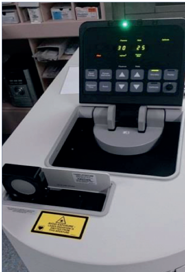
Figure 4. Générateur laser avec la fenêtre de calibration sur le devant et un écran pour calibrer et effectuer les réglages des cathéters optiques.
