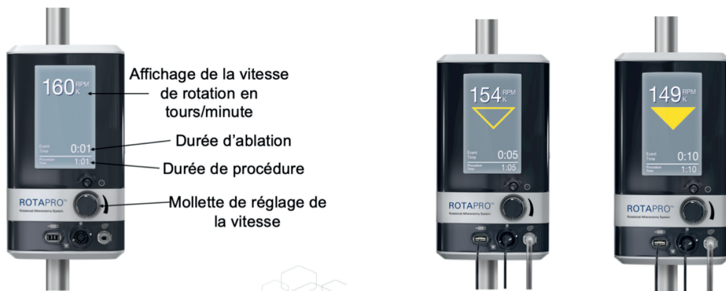
Figure 3. Avant de la console du système ROTAPRO™ (A). Indicateurs de décélération visibles sur l'écran de la console du ROTAPRO™ (B).
