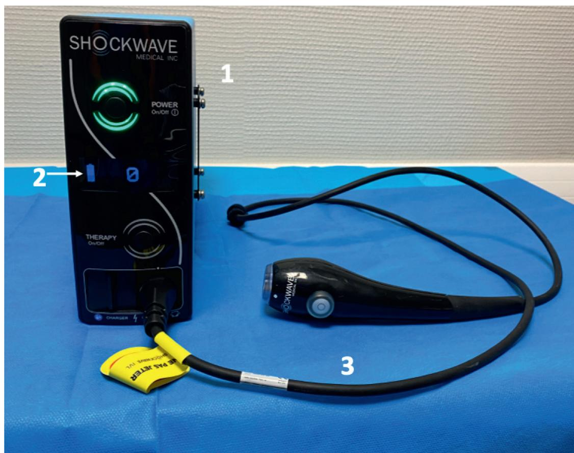
Figure 2. Photo du générateur (1), du niveau de charge (2) et du câble de connexion (3).
