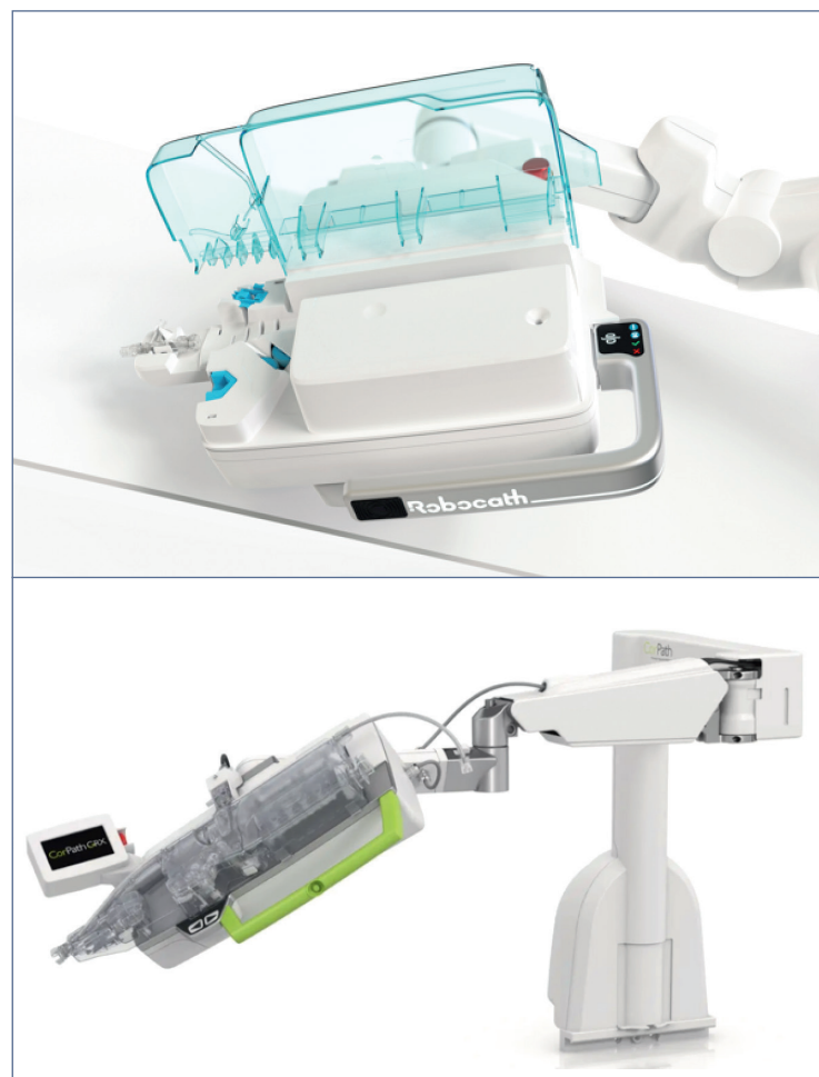
Figure 1. Présentation des deux robots actuels utilisés en cardiologie interventionnelle. En haut, R-One™ (Robocath), en bas CorPath™ (Siemens).
